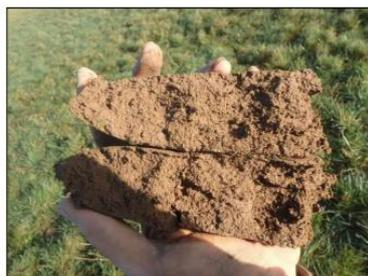
Sondage n°9 : Absence de trace d'oxydo-réduction avant 0,50 m.
