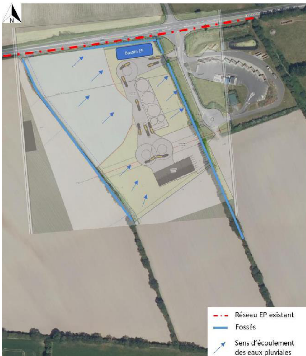
Sens d'écoulement des eaux pluviales et localisation du bassin de stockage
