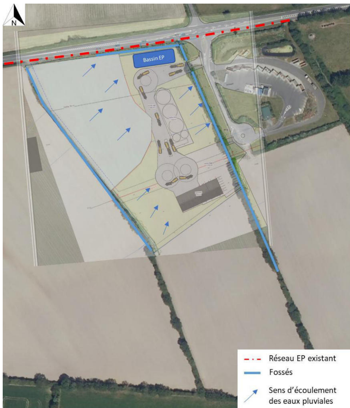
Figure 6 : Sens d'écoulement des eaux pluviales et localisation du bassin de stockage
